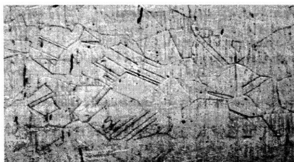
شکل 21-2 تصویر بزرگ شده سطح یک فولاد زنگ نزن 18Ni-8Cr که در محلول اسیدی که اچ شده است 26 .
