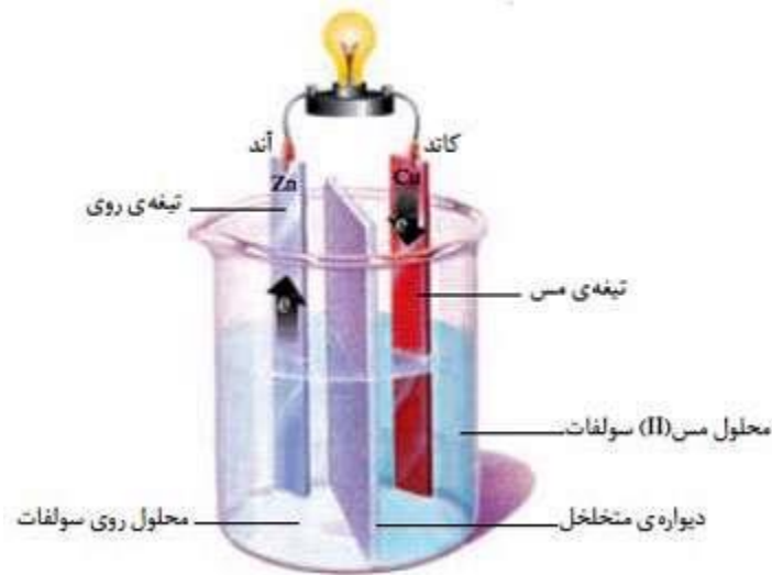
شکل 2-26 شمایی از پیل الکتروشیمیایی گالوانی مس- روی.
