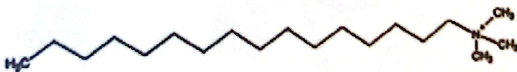
شکل ۵-۱. ساختار CTAB که یک سورفکتانت معمولی مورد استفاده در میکروامولسیون است.
