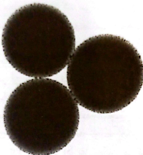
شکل ۱۰-۱۰. رسوب نانوذرات نقره بر روی کره‌های سیلیکونی
