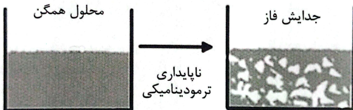
شکل ۱۳-۱۵. طرح شماتیکی روش جدایش فاز.
