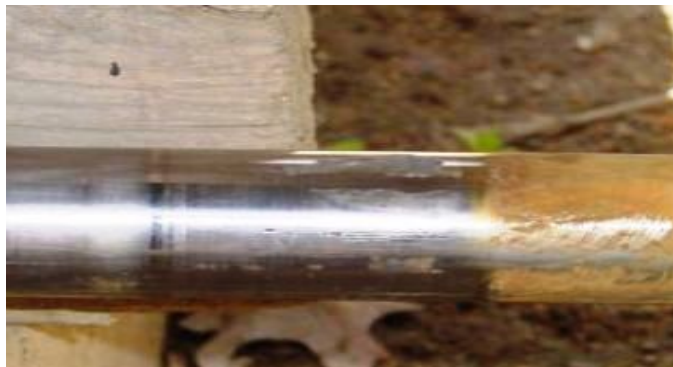
شکل ۴۲: خوردگی شیاری یک کویل حرارتی [۴]
